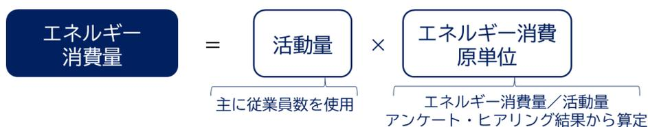
図 3-2 エネルギー消費量の算定方法（積み上げ法による算定）
