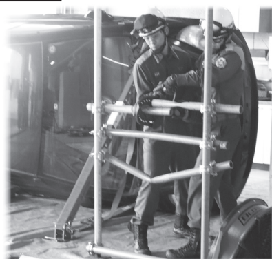
▲バッテリー式油圧救助器具（電動カッター）を用いた実演説明
