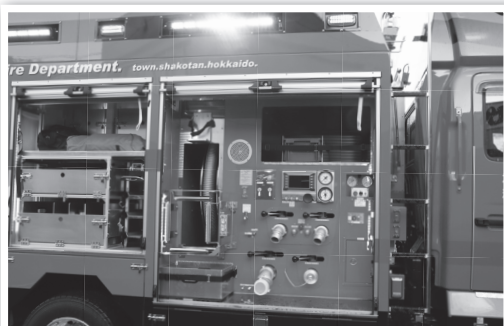
▲道内初の吸管巻取装置（中央）が完備。左右どちらからも作業ができるなど積丹支署に特化した車両。
