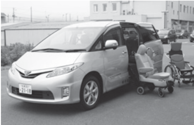
▲シートが稼動することで車いすからの乗降がしやすいサイドリフトアップシート車両。
