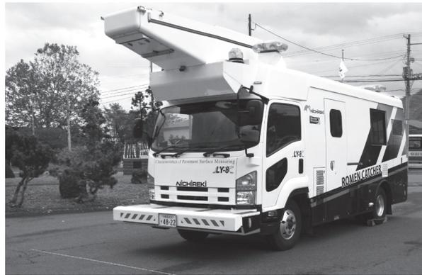
▲車両前方にレーザーを射出し測定を行う特殊車両
